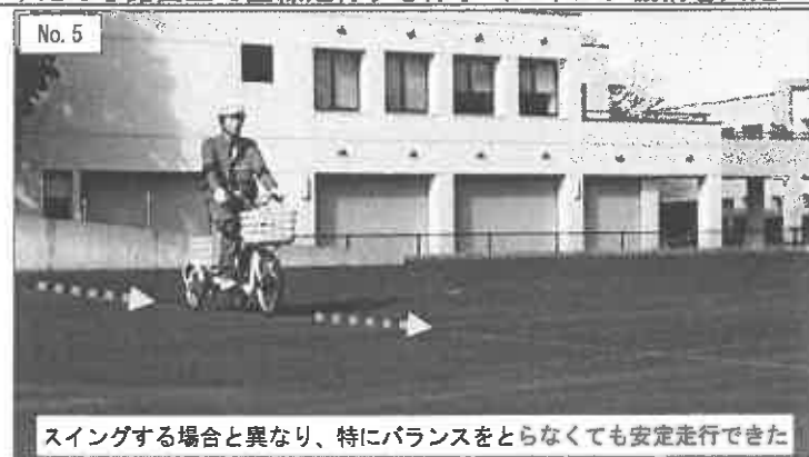
写真5. 平坦な路面上で直線走行する様子（スイング機構を固定した場合）
