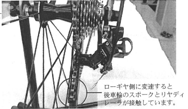
写真 15. ディレーラハンガーが曲がったために、リヤディレーラとスポークが接触する様子 (No. 2)
