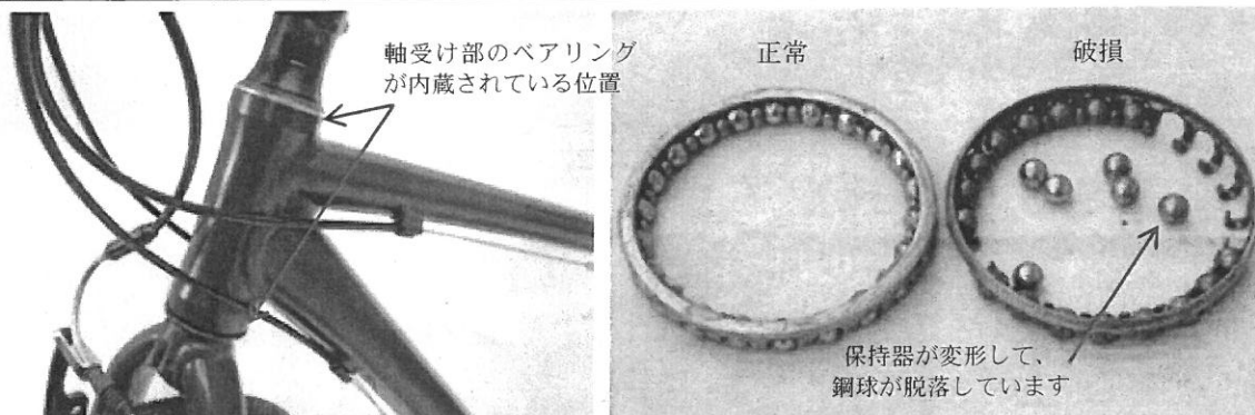
写真5. 軸受け部にガタつきが生じたまま走行した結果、破損したベアリングの様子 (No. 4)
